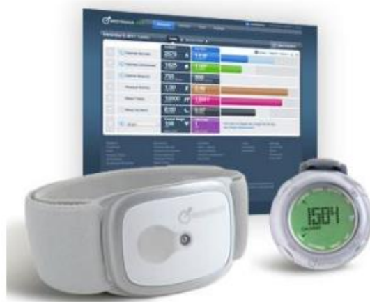
Рис. 1.7. Система моніторингу активності ручного бандажа з датчиками для вимірювання руху, температури, потовиділення та випромінюваного тепла.[16]
