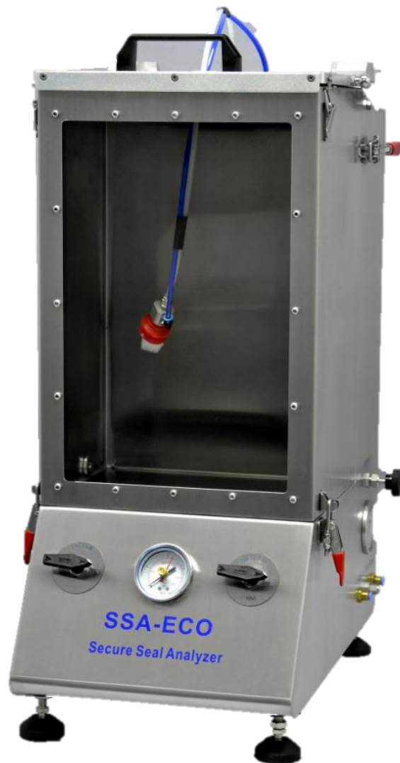
Рисунок 1.1 – Пристрій для перевірки герметичності скляних пляшок [4]
