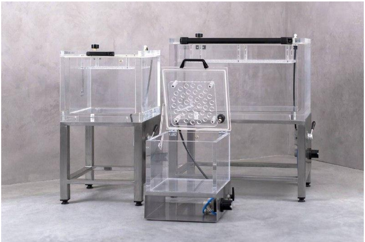
Рисунок 1.2 – Пристрій для перевірки герметичності упаковок [5]
