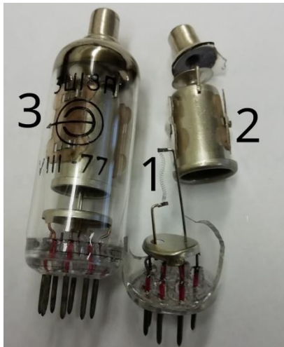
Рис.4. Електронна лампа, яка використовується в лабораторній роботі. 1- катод, 2 – анод, 3 – загальний вигляд лампи.
