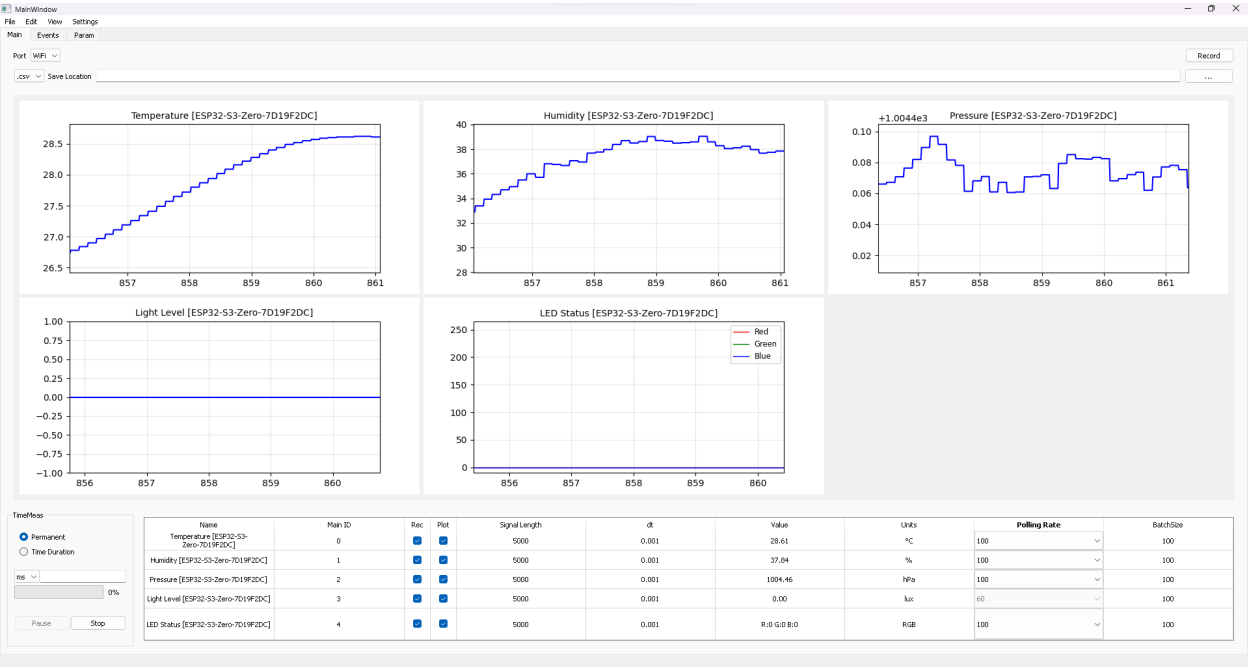
Рисунок 4.3 — Графік зміни температури та вологості у часі при тестовому нагріві
