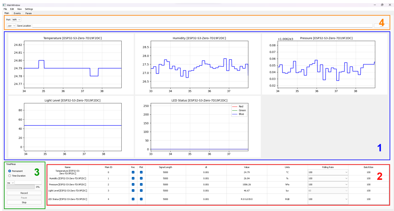
Рисунок 4.2 — Головне вікно програми в режимі моніторингу даних у реальному часі: 1 — Область динамічної візуалізації даних (відображення температури, вологості, тиску, освітленості та RGB-статусу); 2 — Таблиця конфігурації та моніторингу сенсорів (відображення поточних значень, налаштування частоти опитування та вибір каналів для запису/відображення); 3 — панель керування запису експеримента (вибір режиму запису, старт/пауза/стоп, індикація прогресу); 4 — налаштування збереження файлів (вибір директорії для збереження CSV-файлів та активація режиму запису).
