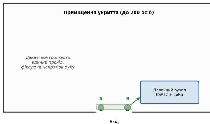
Рис. 4.2 — Схема розміщення давачів в укритті
