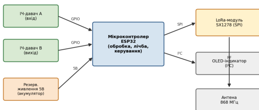
Рис. 4.1 — Структурна схема давачного вузла
