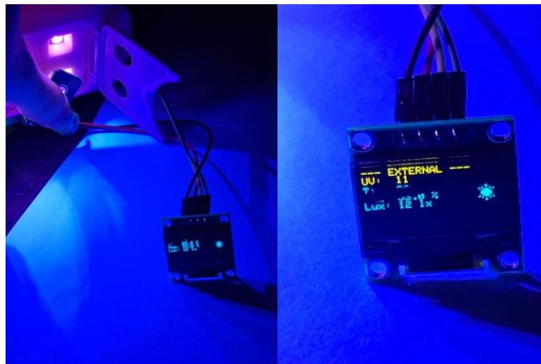
Рисунок 3.16 - Експериментальна верифікація захисних алгоритмів при високому УФ-індексі: а) опромінення сенсора УФ-лампою; б) Телеметрія екрана (UV: 11).
