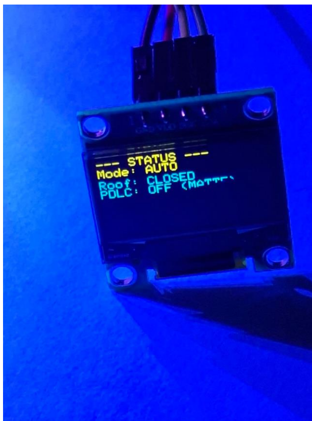
Рисунок 3.17 - Стан вихідних тригерів на екрані STATUS
