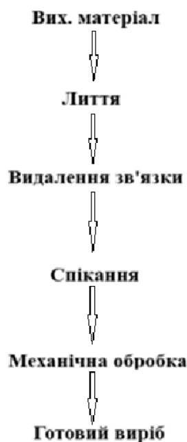
Рисунок 1.7 – Технологічна послідовність інжекційного лиття металів (MIM) [9]
