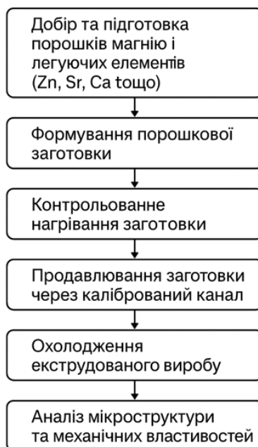
Рисунок 1.3 – Послідовність етапів гарячої екструзії магнієвих сплавів [2]
