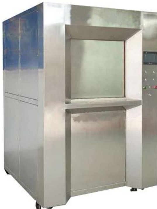
Рисунок 1.16 – Зовнішній вигляд установки для електролітичного плазмового полірування [23]
