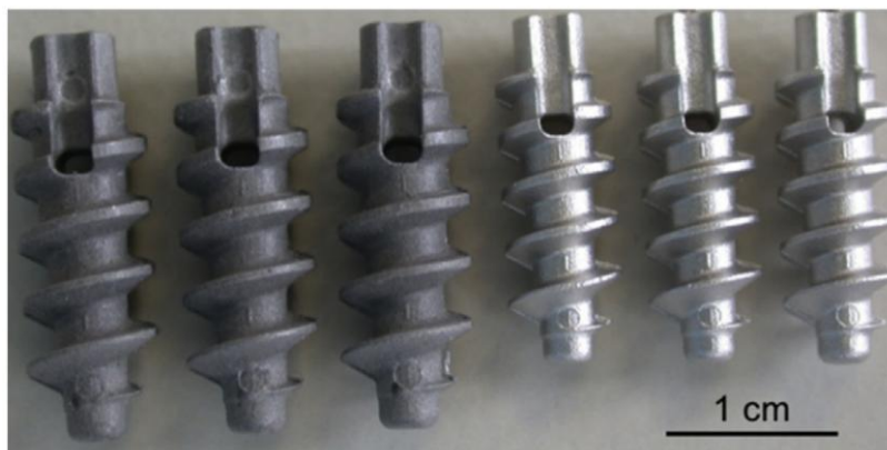
Рисунок 1.6 – Деталі демонстраційного зразка гвинта для анкерного імплантату, виготовлені методом МІМ з порошкового матеріалу EZK400 у необробленому та спеченому стані [7]
