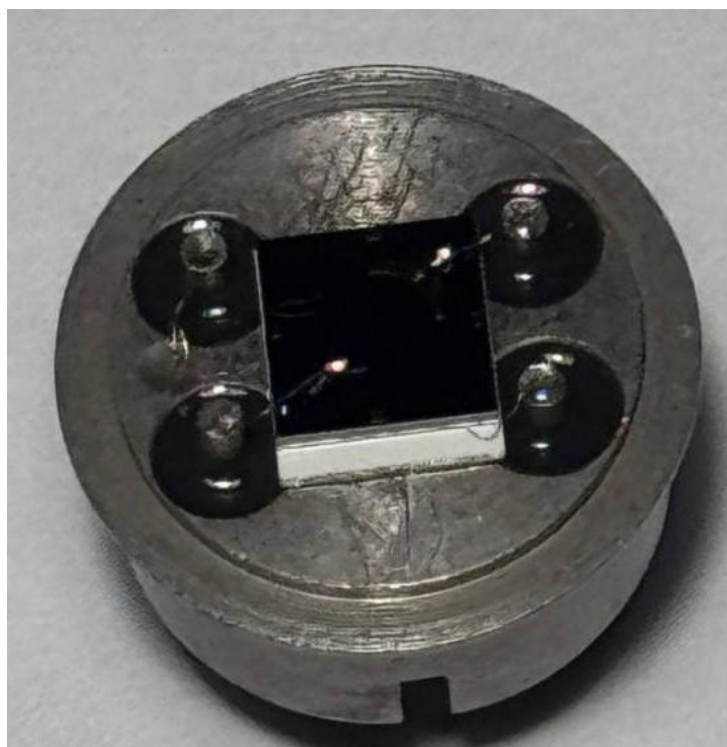
Рисунок 3.8 — Вигляд кристала кремнієвого фотодіода
