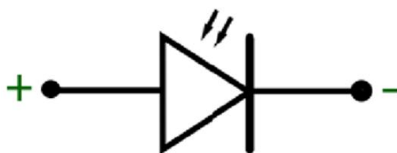
Рисунок 3.7 — Позначення фотодіода в електричних схемах
