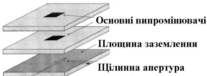
Рис. 1.1.6. Широкопasmовий дворезонаторний смужковий випромінювач із живленням за допомогою щілинної апертури
