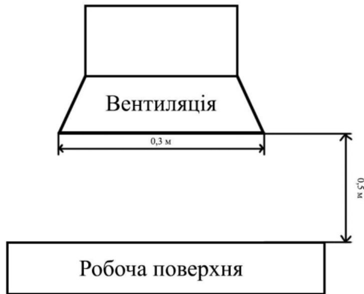
Рисунок 4.2 – Схема місцевої вентиляції
