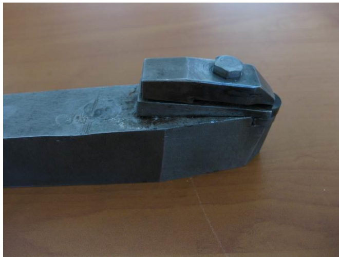
Рисунок 2.7 – Спеціальний різець для закріплення зразка ріжучого АТП, що досліджується
