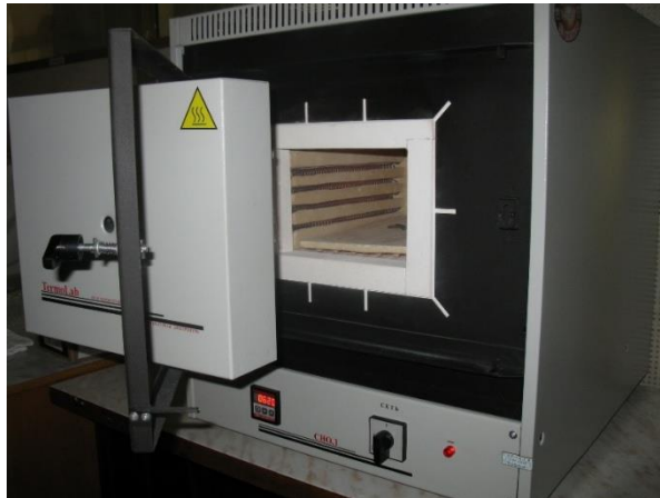
Рисунок 3.16 – Загальний вигляд муфельної печі СНОЛ-1300 для проведення експериментів із визначення термостійкості отриманих КОМПОЗИТІВ.
