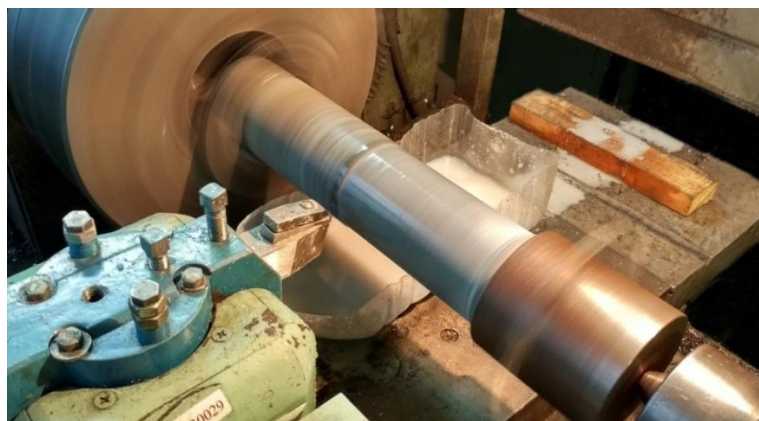
Рисунок 2.8 – Випробування на інтенсивність зношування на токарно-гвинторізному верстаті ФТ - 11
