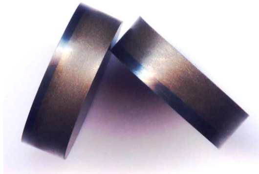
Рисунок 3.4 – Оброблена та готові до випробувань пластини АТП з активуючими добавками
