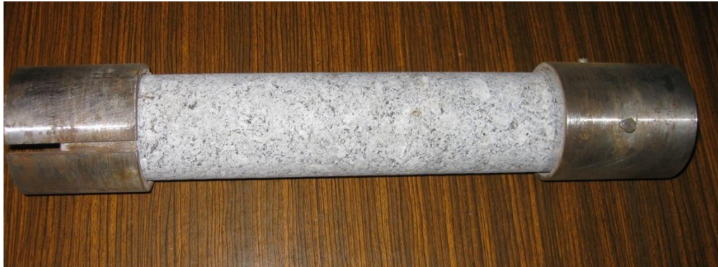
Рисунок 2.6 – Спеціальне пристосування для закріплення керну
