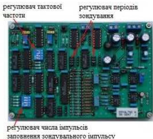
Рис. 8. Зовнішній вигляд монтажної плати формувача
