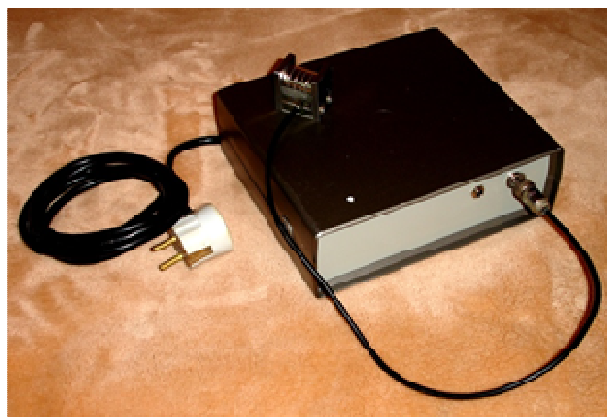
Рис. 9. Конструкція формувачів імпульсів зондування макета
