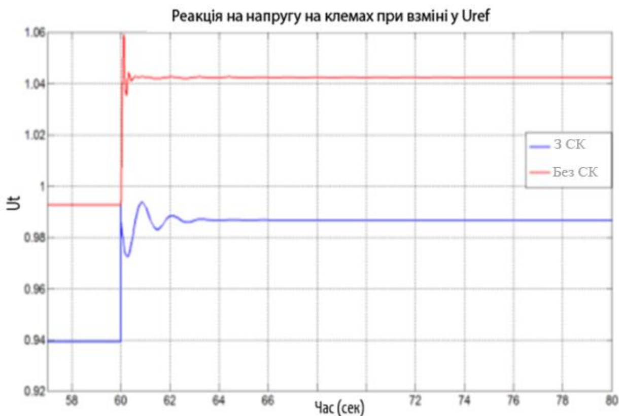
Рисунок 4.12 – Реакція напруги на виході при зміні U_{ref}
