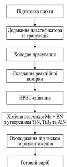
Рисунок 1.6 – Технологічна схема виготовлення PcBN методом реакційного спікання
