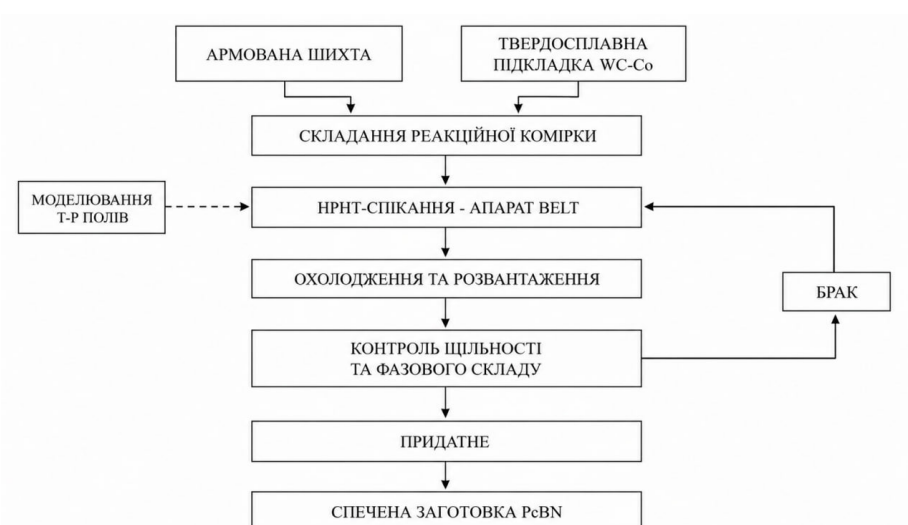
Рисунок 1.13 – Технологічна схема термобаричного спікання
