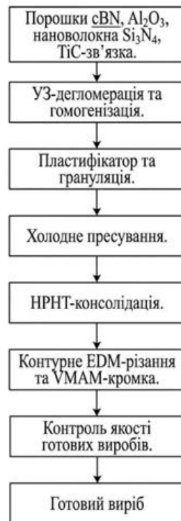
Рисунок 1.7 – Технологічна схема виготовлення інтелектуального інструменту марки BN100+ методом спікання з попередньо синтезованою матрицею
