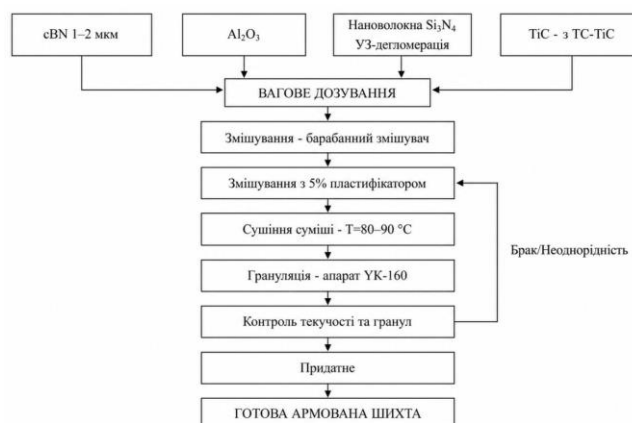
Рисунок 1.12 – Схема підготовки армованої шихти
