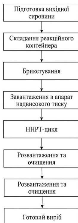
Рисунок 1.5 – Технологічна схема отримання надтвердих матеріалів методом прямого фазового перетворення hBN → cBN
