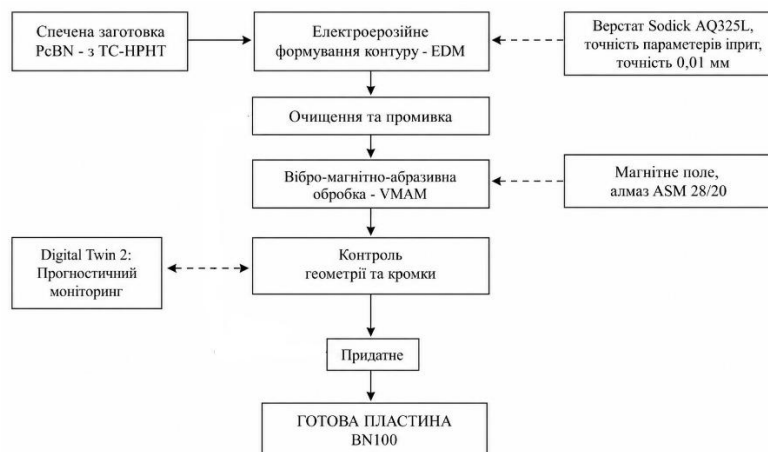
Рисунок 1.14 – Схема фінішної обробки різальних пластин
