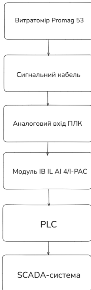
Рисунок 2.4 – Схема каналу вимірювання витрати
