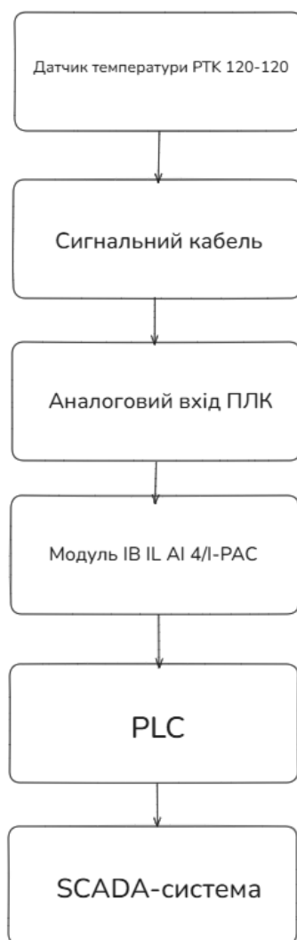
Рисунок 2.1 – Схема каналу вимірювання температури
