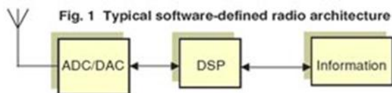
Рисунок 1.1 - Спрощена архітектура типового Software Defined Radio.
