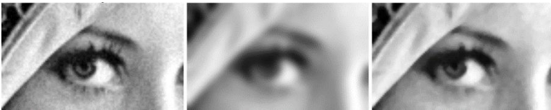
Рис. 8. Результат застосування фільтрації для подавлення цифрового шуму: а) вихідне зображення; б) фільтр Гауса; в) медіанний фільтр
