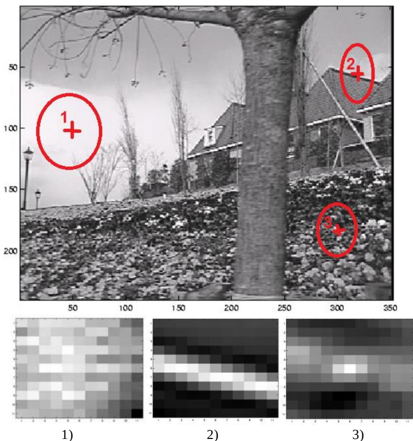
Рис. 1.4. Функція автокореляції в околі точок для різних регіонів зображення
