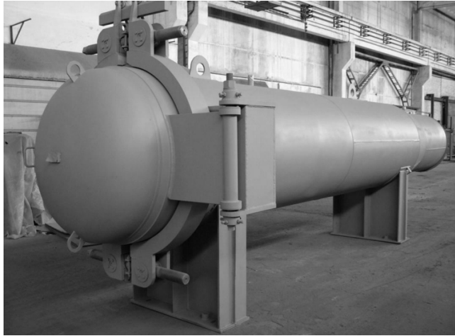
Рисунок 3.2 – Фото камери пуску та прийому засобів очистки і діагностики магістральних трубопроводів (фото підприємства)
