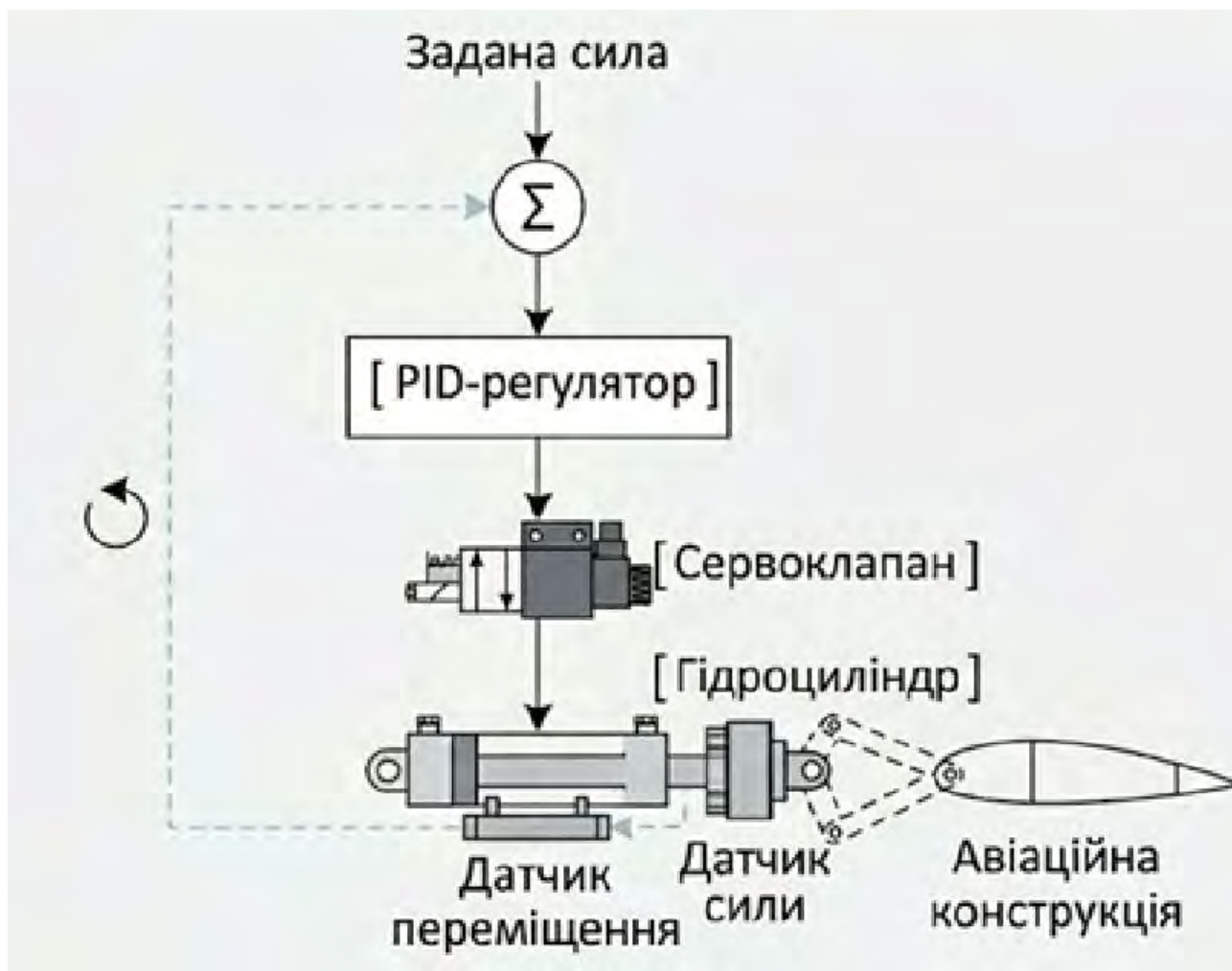
Рис. 3.3 - Функціональна схема одного завантажувального каналу
