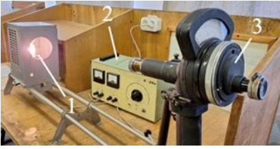
Рис.8. Вид лабораторної установки. 1- лампа розжарення; 2 – блок живлення; 3 – пірометр.
