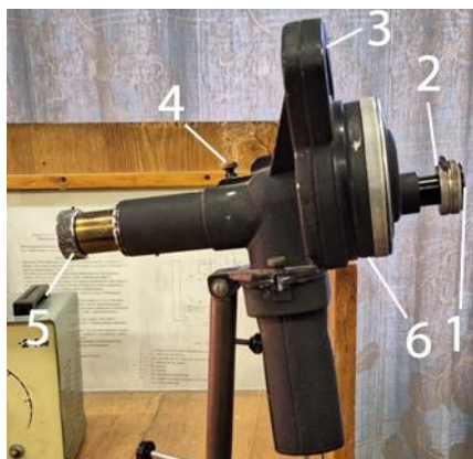
Рис.4.Зовнішній вигляд пірометра із зникаючою ниткою. 1- окуляр, 2- червоний світлофільтр, 3- шкала амперметра, 4- гвинт послаблюючого світлофільтра, 5- об'єктив, 6- реостат.
