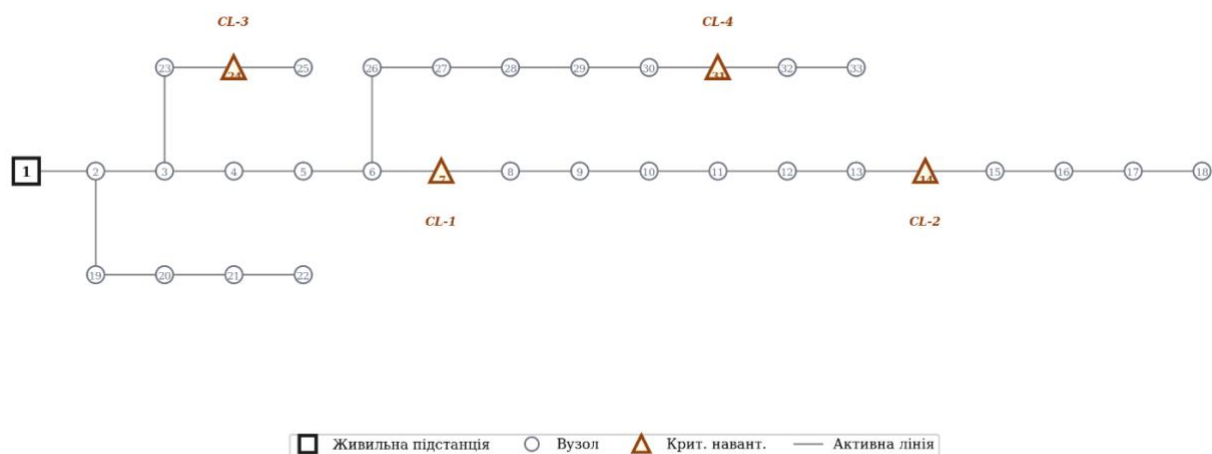
Рисунок 1.1 – Топологія традиційної радіальної розподільчої мережі
