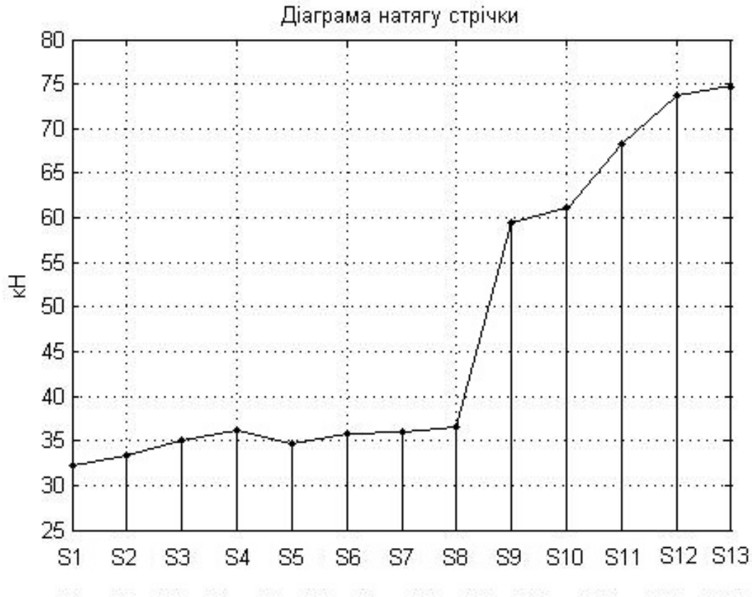
Рисунок 2.2 – Діаграма натягу стрічки конвеєра
