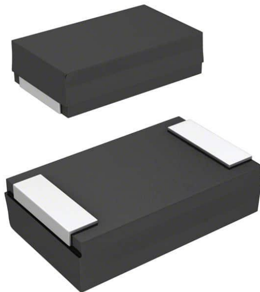
Рисунок 3.11 – Конденсатор танталовий 2917 SMD
