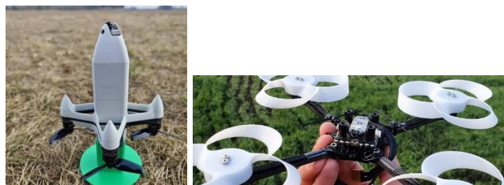
Рисунок 1.10 – Приклади 3D-друкованих компонентів БПЛА.
