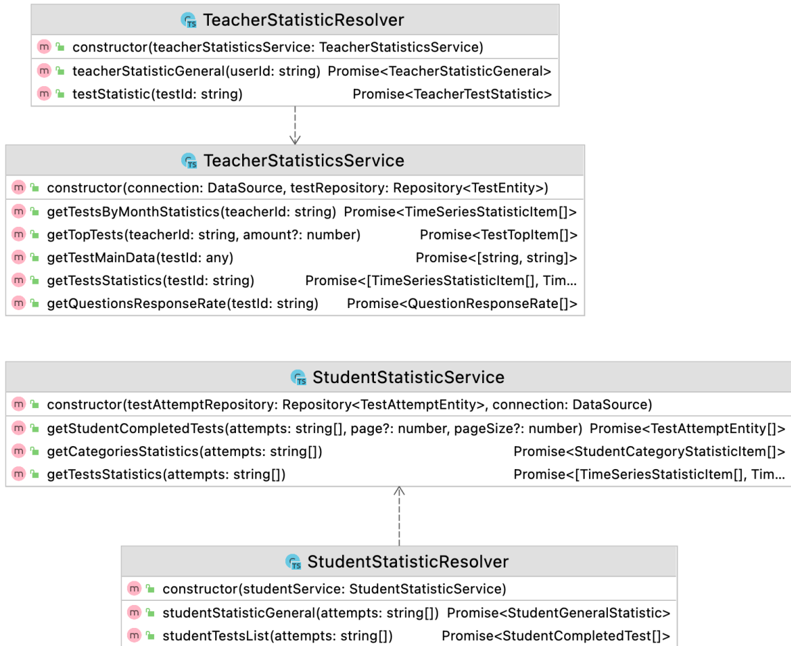
Рисунок 4.6 – Схема класів модуля статистики
