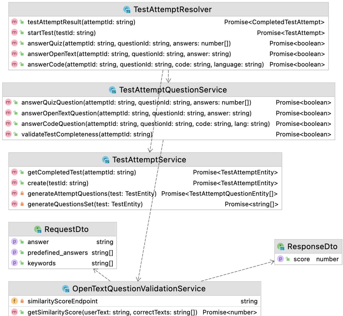
Рисунок 4.9 – Схема класів модуля виконання тестових завдань
