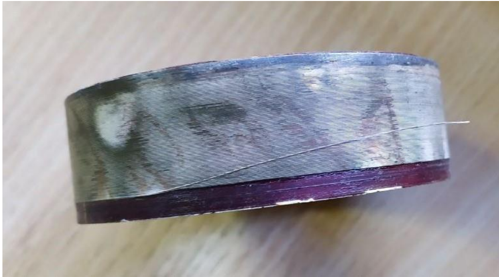
Рис. 2.3. Стальний дріт намотаний на підбандажний шар перетворювача
