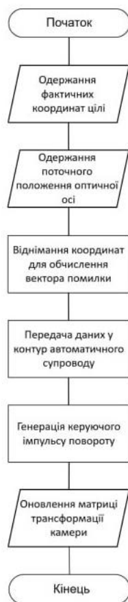
Рисунок 1.1 - Структурна схему взаємодії обчислювальних блоків системи автоматичного супроводу.
