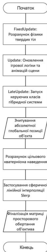
Рисунок 1.4 - Блок-схема алгоритму роботи гібридної системи керування камерою
