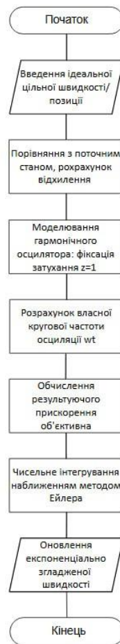
Рисунок 2.5 - Структурна схема регулятора плавності на базі моделі критичного затухання
