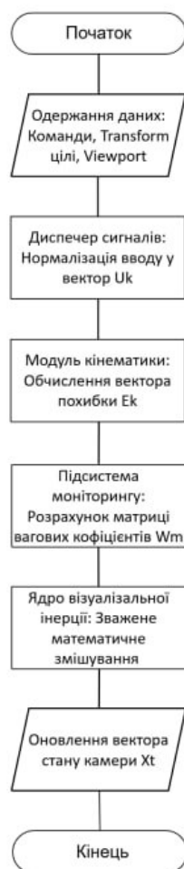
Рисунок 2.1 - Алгоритм взаємодії модулів кінематики та моніторингу для розрахунку параметрів руху
