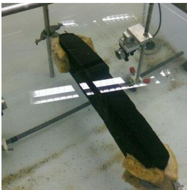
Рисунок 1.4 – Ультразвукове дослідження структури археологічного об'єкту
