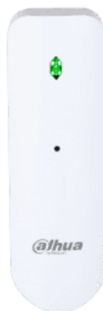
Рисунок 1.5 – Звуковий замок, що детектує звук розбитого скла
