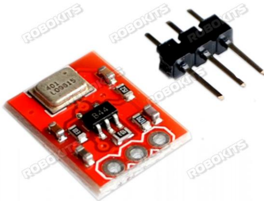
Рисунок 2.14 – Analog Devices ADMP401
