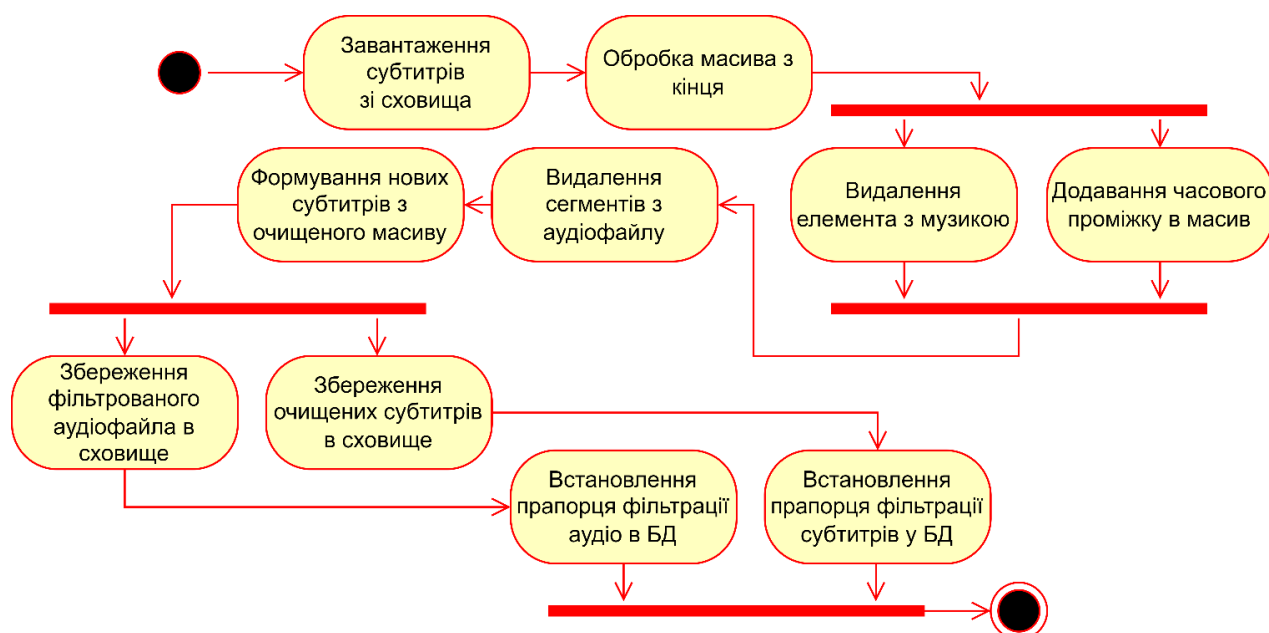
Рисунок 9 – Діаграма діяльності алгоритму фільтрації аудіофайлів від музики
