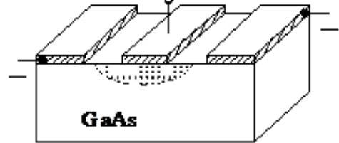
Рис. 4.12. Компланарна лінія передачі на напівпровідниковій підкладинці
