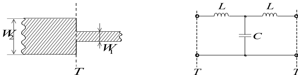
Рис. 4.29. «Стрибок» хвильового опору і його схемна модель
