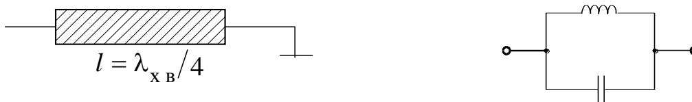
Рис. 4.36. Резонатор у вигляді чвертьхвильового короткозамкненого відрізка лінії і його схемна модель
