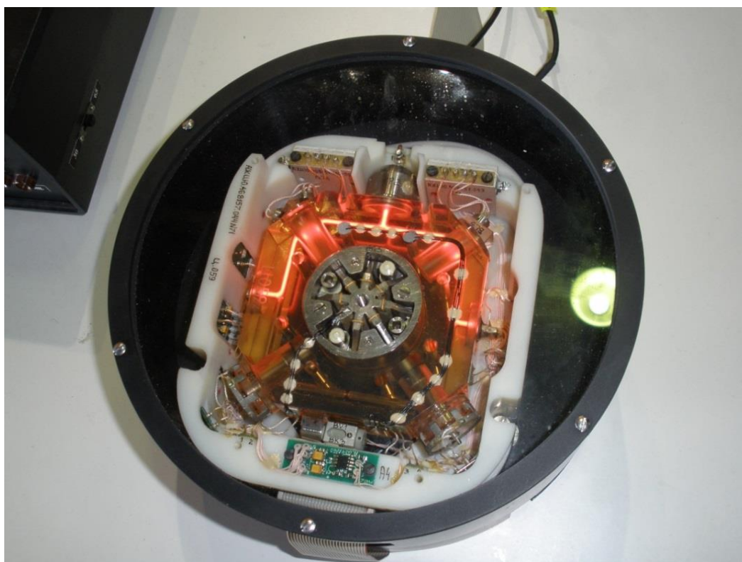
Рис. 1.1 Кільцевий лазерний гіроскоп [1]
