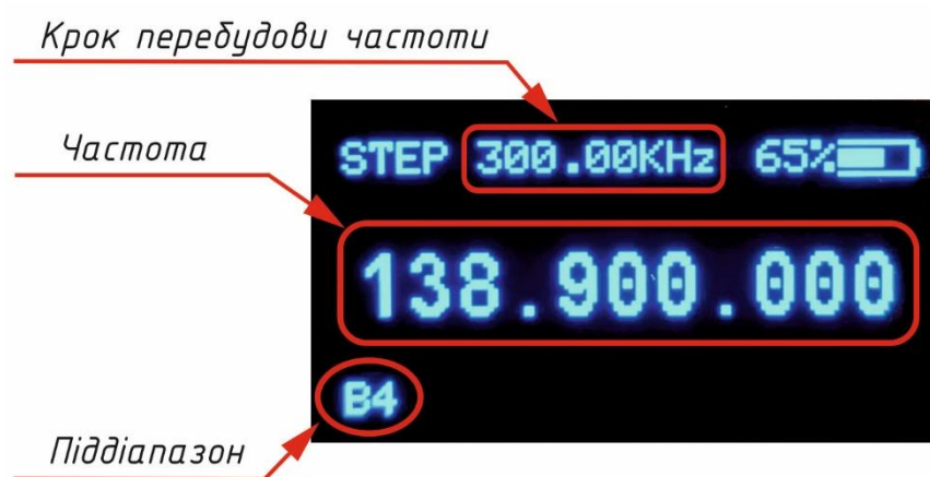
Рисунок 7.4 – Індикація основних параметрів універсального гетеродина (головний екран)
