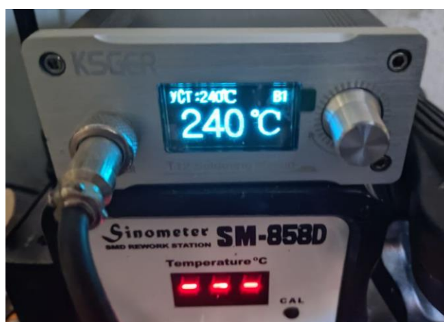
Рисунок 7.1 – Паяльна станція і термофен, які були застосовані для монтажу пристрою
