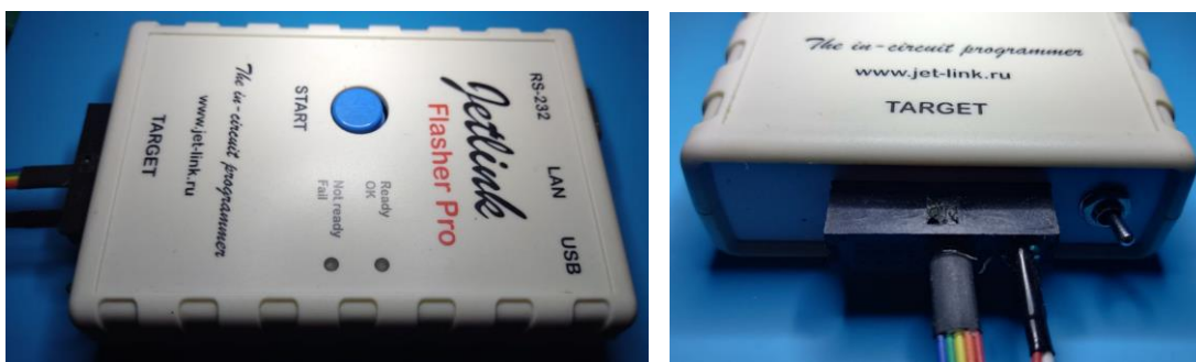
Рисунок 2.26 – Програматор JetLink Pro, який використовувався для програмування мікроконтролера STM32F030K6T6
