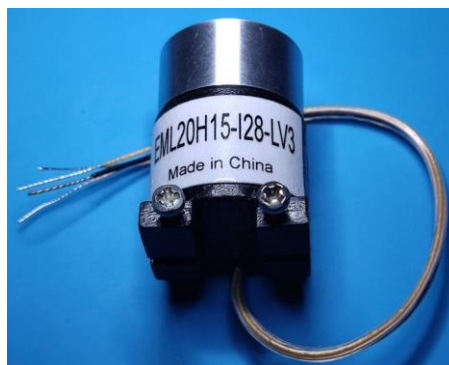
Рисунок 2.16 – Зовнішній вигляд магнітного інкрементного енкодера EML20H15-I28-LV3
