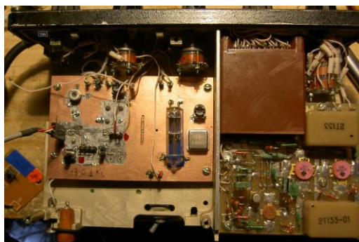
Рисунок 1.8 – Штатний синтезатор (плати обведені зеленою лінією) радіостанції «Яшма-Н» (а) і результати його заміни радіоаматорами на сучасний синтезатор (б)
