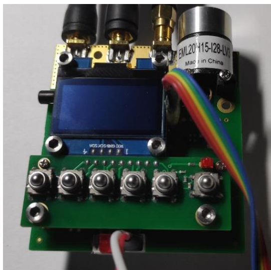
Рисунок 7.3 – Змонтований універсальний гетеродин з блоком індикації та керування
