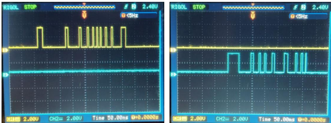
Рисунок 2.18 – Зміна тривалості імпульсів у залежності від швидкості обертання ротора енкодера EML20H15-I28-LV3 у різних напрямках
