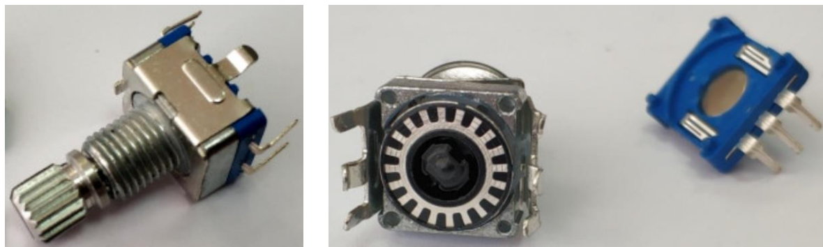
Рисунок 2.12 – Зовнішній вигляд та внутрішня будова дешевого контактеного енкoderа
