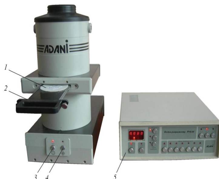
Рис. 9. Загальний вигляд бета-радіометра РУБ-91 «АДАНІ»: 1 - досліджуваний зразок (проба); 2 - предметний столик; 3 - кнопка включення і виключення приладу; 4 - кнопка включення високовольтних джерел живлення ФЕУ; 5 - блок аналізаторів
