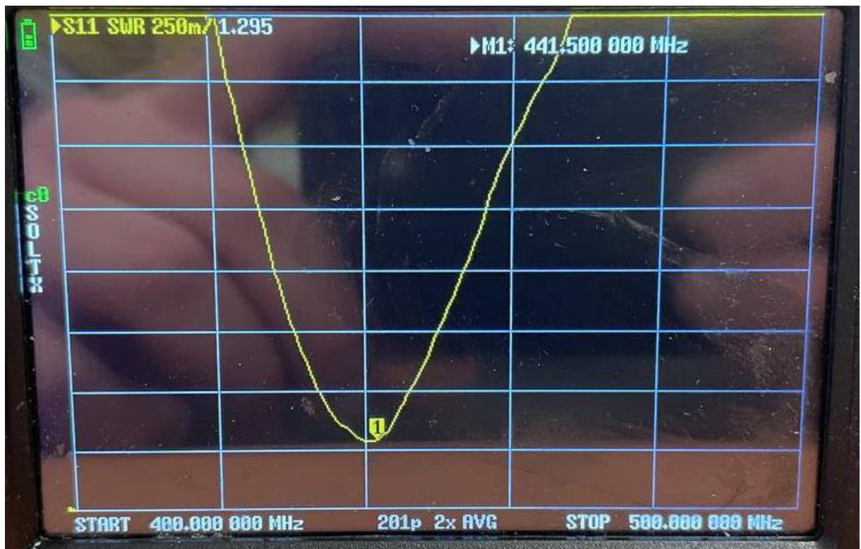
Рисунок 2.6. — Залежність КСХ антени SMA 433MHz від частоти.
