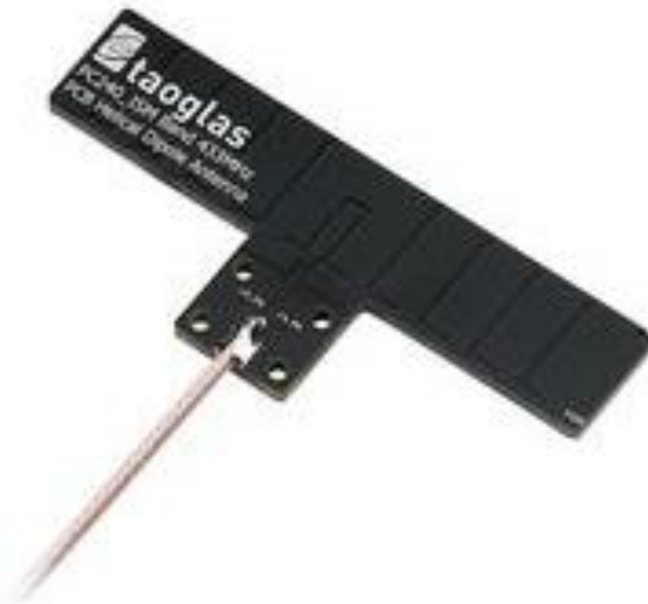
Рисунок 3.1. — Дипольна антена, виконана за технологією мікросмужкових ліній передачі.
