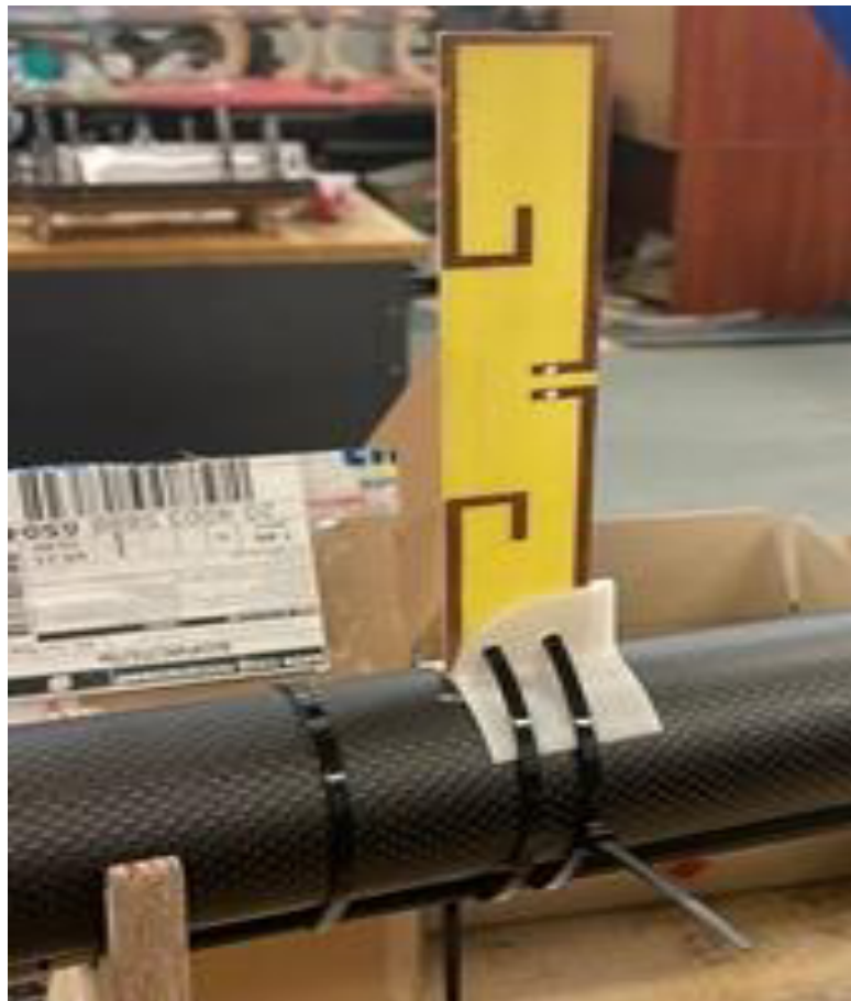
Рисунок 4.2. — Установлена на фюзеляжі БПЛА приймальна антена вертикальної поляризації
