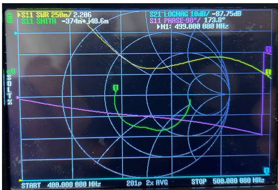
Рисунок. 4.4. — Виміряна залежність КСХ приймальної антени від частоти.
