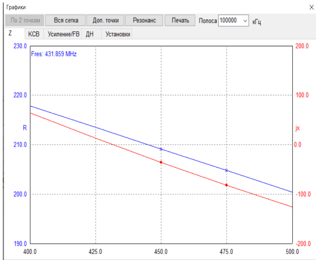
Рисунок 3.21. — Залежність модуля повного вхідного опору логоперіодичної антени від частоти.
