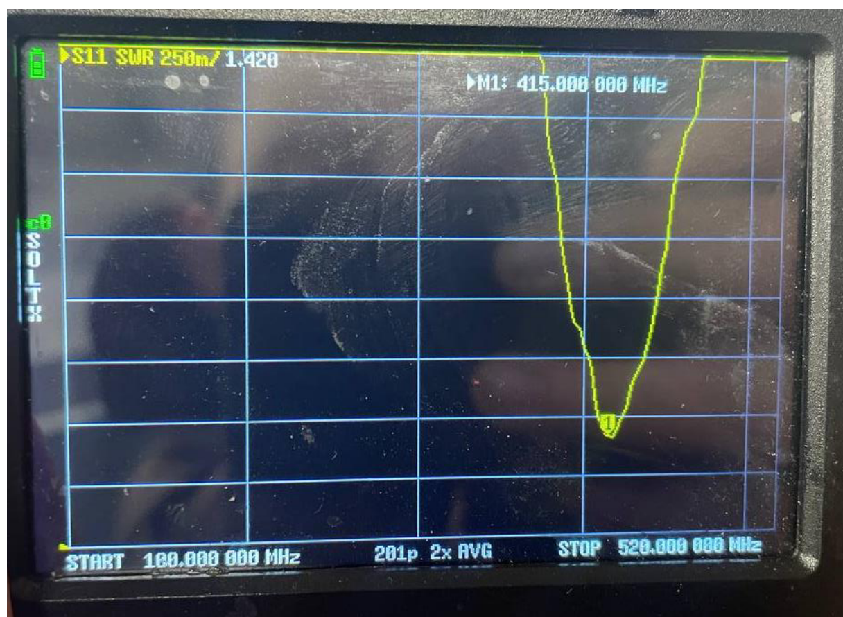
Рисунок 2.4. — Залежність КСХ антени Baofeng UV-10R від частоти.
