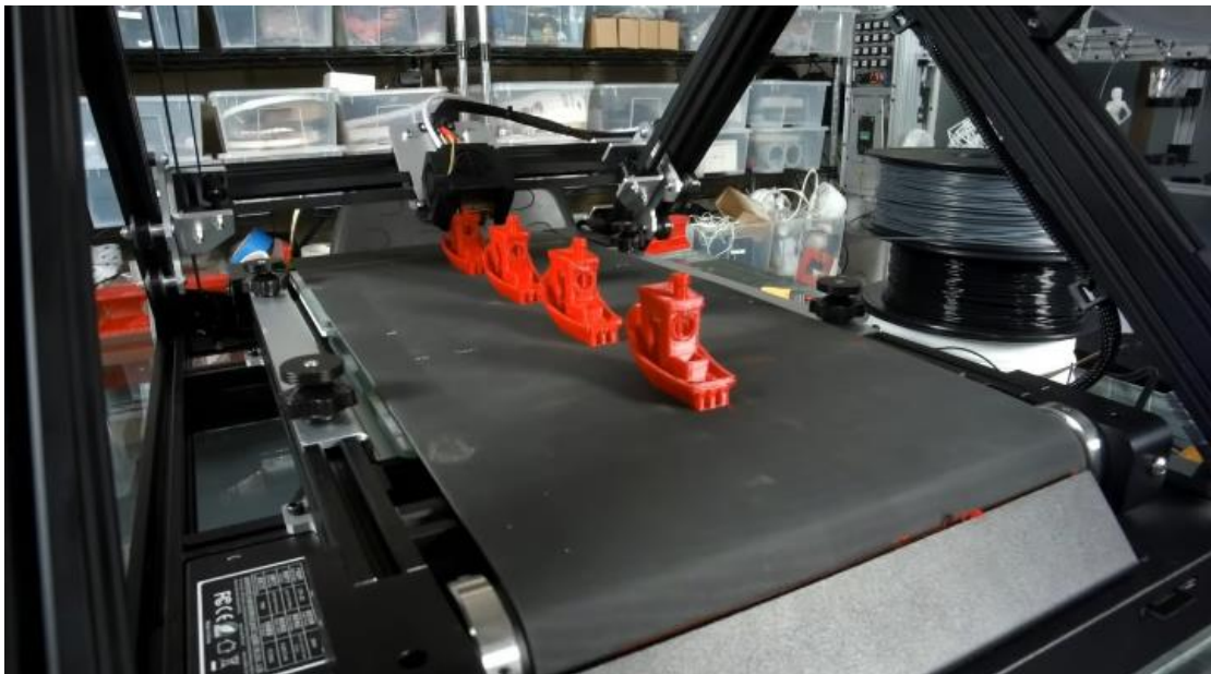
Рисунок 1.13 – Стрічковий 3D-принтер демонструючи «нескінченну» вісь Z у вигляді конвеєрної стрічки [2]
