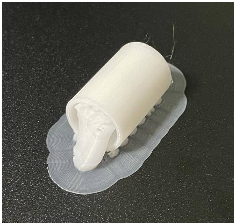
Рисунок 2.5 – Надрукований циліндр за другою керуючою програмою
