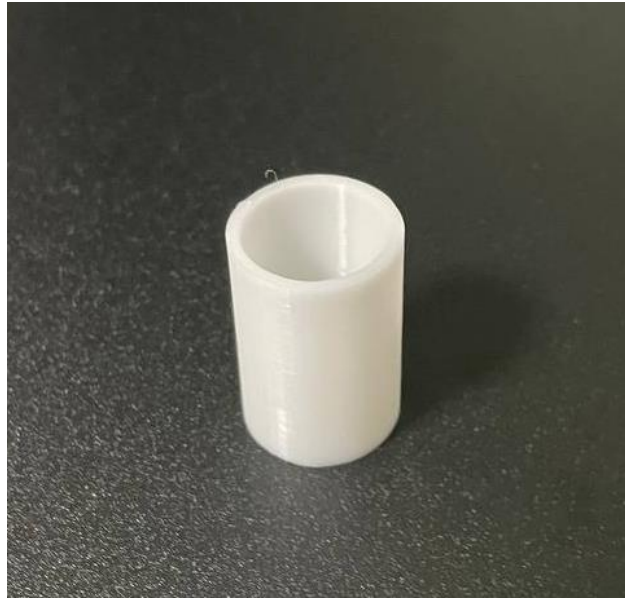
Рисунок 2.3 – Надрукований циліндр за першою керуючою програмою
