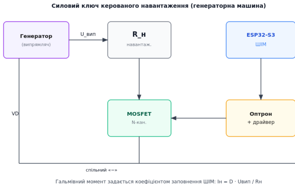
Рисунок 3.5 – Силовий ключ керованого навантаження машини-генератора
