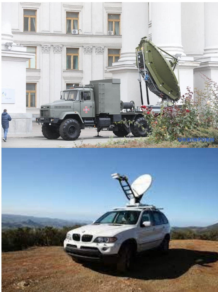
«Рис 1.2.3 — Приклад розміщення пересувних мобільних земних станцій»
