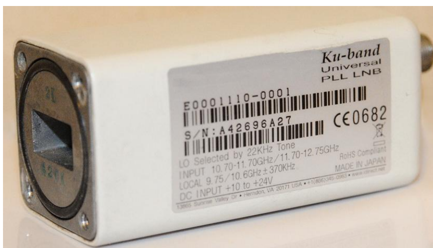
«Рис. 1.4.2.1 — Конвертор Ku-діапазону з перемикаємим опорним генератором»
