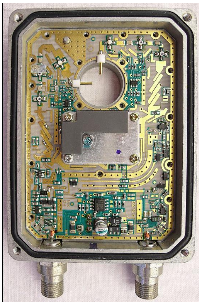
«Рис. 1.4.2 — Розібраний конвертор. Хвилевід , що передає мікрохвильовий сигнал , закінчується в отворі в центрі, де для цього конвертора два контакти виконують роль антен»
