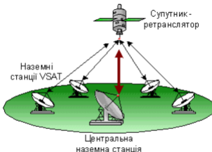
«Рис. 2.4.2 — Топологічна схема мережі типу “зірка”»
