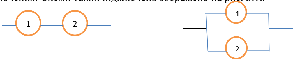
Рис.3.1. Схема А (послідовне підключення) Схема В (паралельне підключення)
