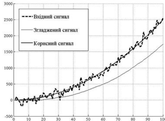
Рис. 7.32. Процес згладжування фільтром Р. Брауна суми квадратично зростаючого сигналу x(k) = 0,25k^2 і випадкового збурення
