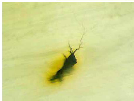
Рис. 5.3. Трїїнг, що зародився на чужорідному включенні в ізоляції
