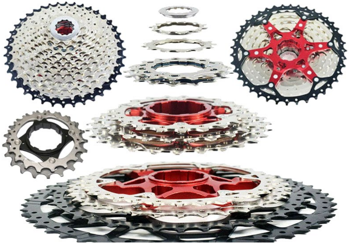
Рис. 1.10. Велосипедні касети на одному павуку
