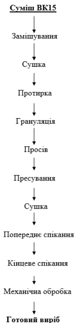
Рисунок 1.6 – Технологічна схема виробництва футерувальних плит з сплаву ВК15
