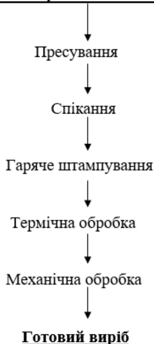
Рисунок 1.2 – Технологічна схема виготовлення деталей з високо-марганцевої сталі марки 110Г13
