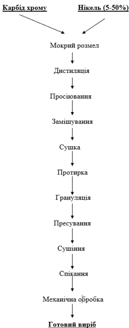
Рисунок 1.4 – Технологічна схема виготовлення виробів з сплаву КХН
