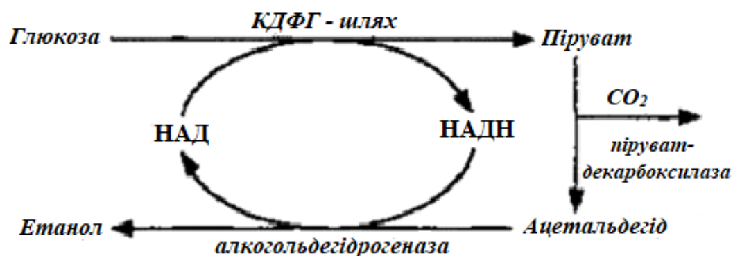
Рис. 2.3 – КДФГ шлях перетворення глюкози на етанол за допомогою бактерії Zyotomonas mobilis [35]
