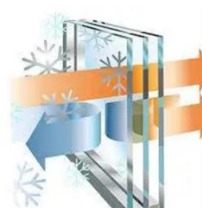
Рисунок 3.11 – Конструкція енергозберігаючих вікон, що пропонуються Опір теплопередачі існуючих вікон R_{існ} , [м 2 К/Вт]
