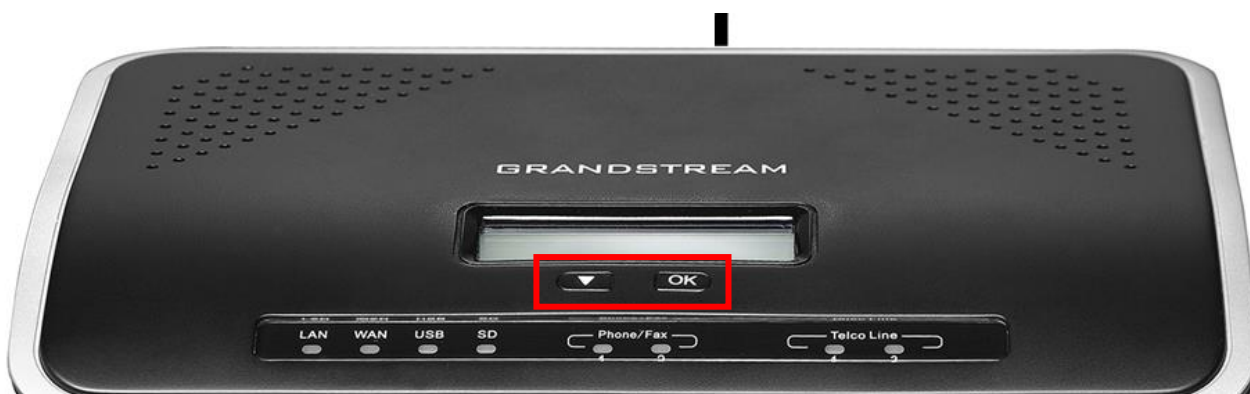
Рисунок 9.2. Кнопки для налаштування АТС через меню вбудованого дисплея
