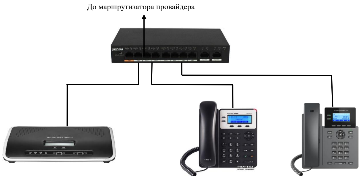
Рисунок 9.1. Схема організації сегменту мережі ІР-телефонії
