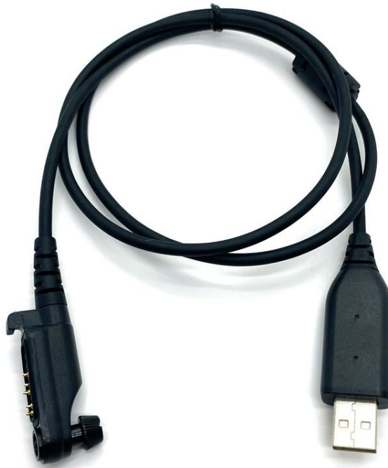
Рисунок 11.2. Кабель для програмування радіостанцій Hytera HP705
