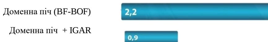
Рисунок 3.3 – Зменшення рівня викидів CO 2 /т.т сталі за технологією IGAR
