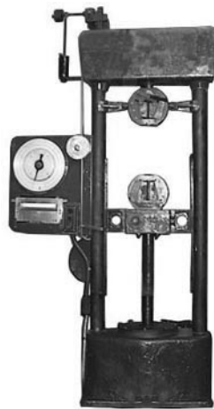
Рис. 4.17. Розривна машина УМ-5
