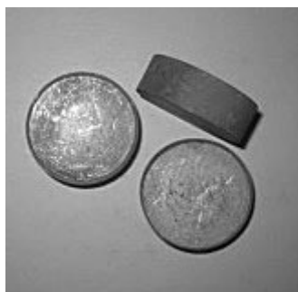
Рис. 4.4. Зовнішній вигляд п'єзокерамічного випромінювача та п'єзокерамічного приймача
