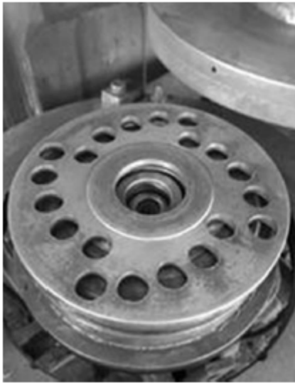
Рис. 1.6. Сепаратор технологічного пристрою (а) і схема розташування отворів у сепараторі (б) [10].
