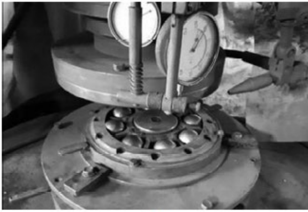
Рис. 1.10. Розташування керамічних куль у пристрої ( а ), вимірювання координати профілю робочої поверхні круга ( б ) [16].
