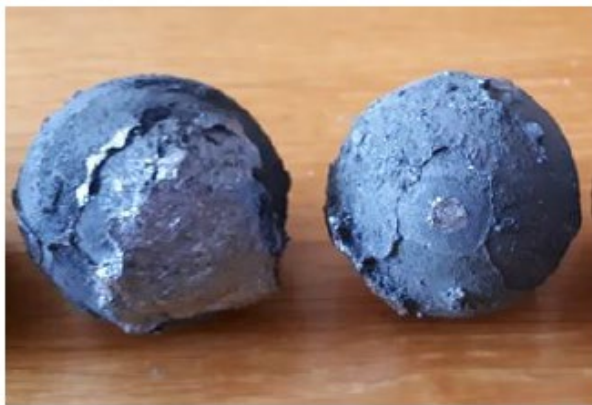
Рисунок 1.2. Так виглядають керамічні кулі після спікання (а), кулі після фінішної механічної обробки (б) [7].
