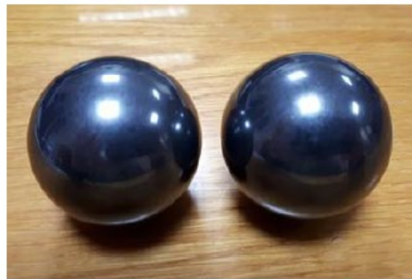
Рисунок 1.2. Так виглядають керамічні кулі після спікання (а), кулі після фінішної механічної обробки (б) [7].
