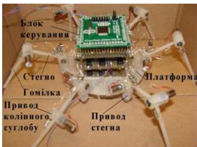
Рис. 1.10. Експериментальний зразок робота – гексапоїда (а) та схема його приводів (б)
