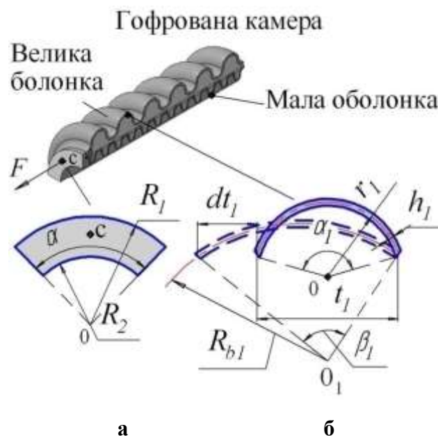
Рис. 4.34. Розрахункова схема гофрованої оболонки а – схема заглушки; б – схема оболонки
