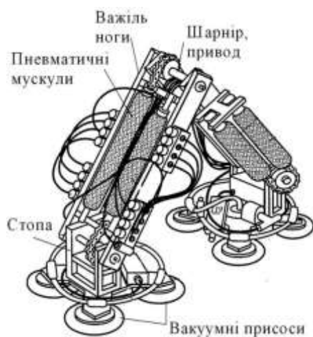
Рис. 1.11. Крокуючий мобільний робот з пневматичними мускулами [40]
