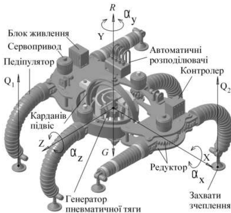
Рис. 5.1. Мобільний РДО з генератором пневматичної реактивної тяги
