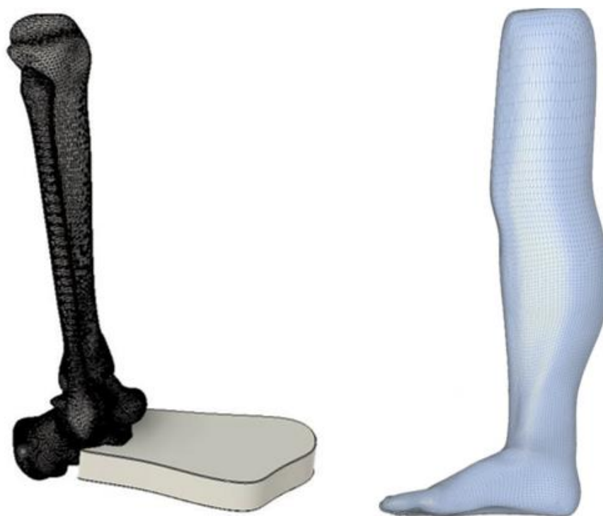
Рисунок 2.3 –Тривимірна модель сурогата «стопа-гомілка»: а) кістковий каркас; б) загальний вигляд із м'язовим масивом (виконано у Fusion 360 )
