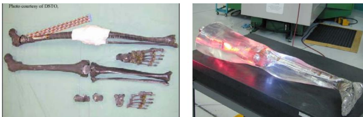
Рисунок 1.5 – Frangible Surrogate Leg : кісткова структура (ліворуч) та готовий виріб (праворуч) [6]
