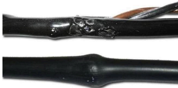
Рисунок – 1.6. Ізоляція електричного кабелю з дефектами
