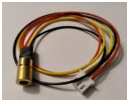
Рис. 4.4. Зовнішній вигляд лазера на довжину хвилі 980 нм.
