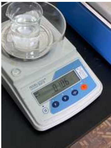
Рис. 3.3. Ваги лабораторні ТВЕ-0.21.
